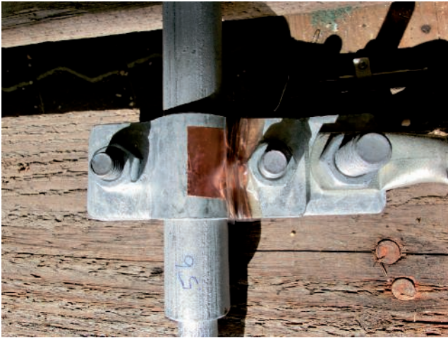
Kurzschlussstromprüfung an Tiefenerderklemme
