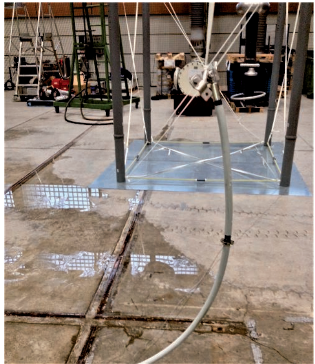
Prüfung der isCon® Pro+ Ableitung
