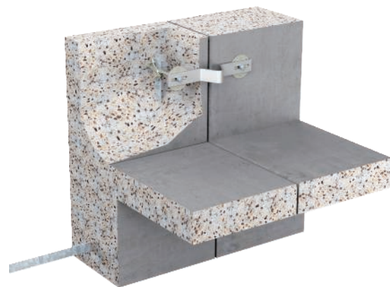
Überbrückung von Bewegungsfugen mit einem Dehnungsstück
