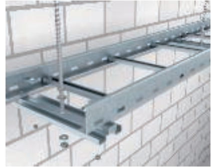
Suspension centrale Suspension par tige filetée d'une échelle à câbles à l'aide de la suspension centrale MAHL et de la tige filetée 2078/M12.
