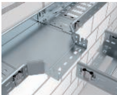
Montage de pièce en Té Magic Montage de pièces de forme par simple emboîtement. Le côté languette du chemin de câbles est inséré par le haut dans le raccord de la pièce de forme.
