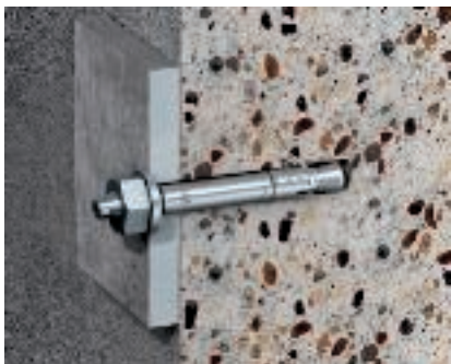
Clou d'ancrage de type N avec raccord fileté Clou d'ancrage de type N avec raccord fileté M6, utilisable dans du béton normal fissuré ou non fissuré C20/25 à C50/60.
