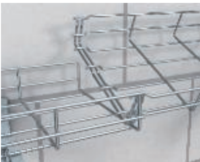
Éclissage de chemin de câbles en treillis Magic® Réalisation d'un éclissage droit sans vis pour le chemin de câbles en treillis type GR-Magic® par emboîtement de deux longueurs de livraison.
