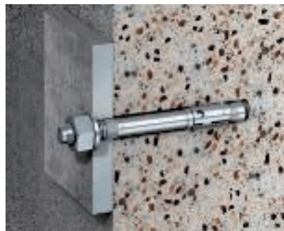
Goujon d'ancrage type BZ Goujon d'ancrage type BZ, pour la fixation d'ancrages pour charge lourde dans du béton normal fissuré ou non fissuré C20/25 à C50/60, approprié pour montage par enfonçage, avec raccord fileté M8, M10, M12 ou M16.
