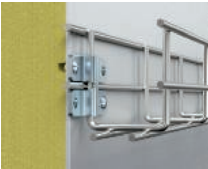
Fixation murale et au sol WB GR Composant de fixation pour le montage direct de chemins de câbles en treillis sur les murs et les sols. À riveter ou à visser. Convient pour l'épaisseur de fil de 3,9 mm.
