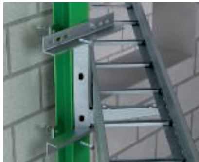
Plaque d'adaptation 45° Montage de la plaque d'adaptation à 45° KA-E 45 sur une poutre métallique avec un crapaud de serrage KWS. Le montage de la plaque d'adaptation peut également être effectué sur des murs en béton avec des chevilles d'ancrage.
