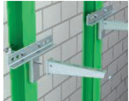
Fixation par crapautage sur poutres métalliques (IPN) verticales Montage de la plaque d'adaptateur type KA-AW sur poutre en acier verticale à l'aide d'éclisses de serrage ou crapauds de serrage. Les consoles murales AW sont fixées à la plaque d'adaptation avec la vis à tête hexagonale de type SKS 12x40 GF.
