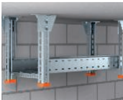
Exemple de montage Montage bilatéral d'un pendart en profilés en U avec barre transversale. Fixation d'un chemin de câbles longue portée WKSG 110 sur le profil transversal avec des boulons TRCC.
