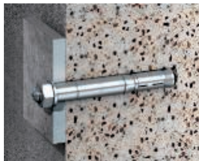
Cheville d'ancrage pour charges lourdes type SZ Cheville d'ancrage pour charges lourdes de type SZ avec raccord fileté M12, pour la fixation de composants supportant des charges importantes, homologuée pour béton normal fissuré ou non fissuré C20/25 à C50/60.
