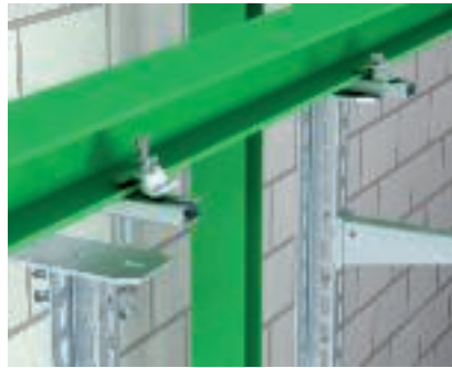
Fixation par crapautage avec profilé en C supplémentaire Utilisation d'un rail profilé en C supplémentaire type MS sur les poutres métalliques plus larges. Cheminement parallèle à la poutre en acier.
