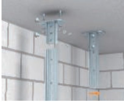
Montage des plaque de tête Fixation de la plaque de tête standard KI 8 pour pendants en I sur plafond en béton à l'aide de goujons d'ancrage.
