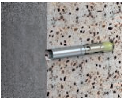
Goujon d'ancrage type BZ-IG Le goujon d'ancrage BZ-IG taraudé est homologué pour des trous normaux et non contredépouillés. Dans le cadre de l'Agrément technique européen ETA-99/0010 pour béton fissuré ou non fissuré, il est possible d'utiliser des vis à six pans et des vis à tête fraisée ainsi qu'un système à base d'écrou, de rondelle et de tige fileté courante.
