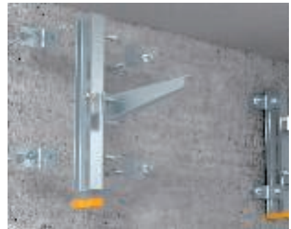
Fixation murale d'un montant en I Montage d'un pendeur en I au mur avec équerres de fixation de type BW 80/55 et goujons d'ancrage pour loger plusieurs consoles de pendeur de type AS.
