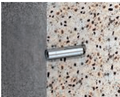
Cheville à frapper type ES Cheville à frapper type E avec filet femelle M6, M8, M10, M12. Pour supporter de petites charges, homologuée pour les fixations multiples dans le béton fissuré et non fissuré de systèmes non porteurs.
