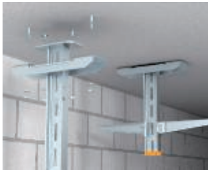
Semelle d'adaptation symétrique Semelle d'adaptation symétrique KA-SY permettant d'augmenter la capacité de charge (à associer aux pendants de type US 7 K et IS 8 K).
