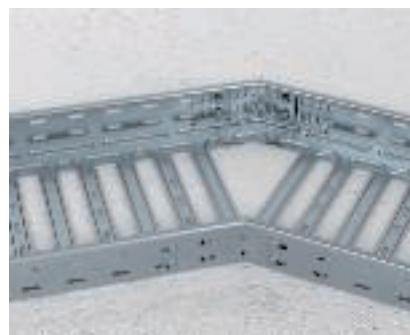
Changement de direction avec chemins de câbles séparés Assembler les chemins coupés et les fixer de l'intérieur au niveau du couvre-joint avec une éclisse d'angle de type RWVL.
