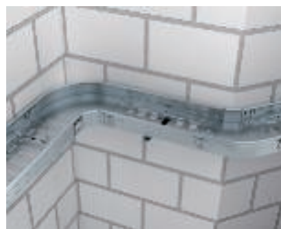
Montage d'un coude Magic Montage de pièces de forme par simple emboîtement. Le côté languette du chemin de câbles est inséré par le haut dans le raccord de la pièce de forme.
