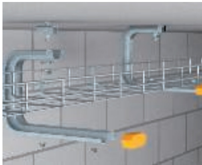
Montage au plafond avec console murale et de plafond de type TPD Montage au plafond d'un chemin de câbles en treillis avec console murale et de plafond de type TPDG. La fixation du chemin de câbles en treillis s'effectue sans vis sur le support de plafond.
