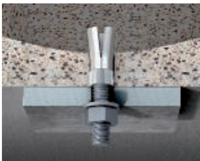
Cheville pour plafond creux de type Easy Cheville pour plafond type Easy avec filet femelle M6, M8, M10 et M10, pour utilisation dans plafonds à dalles creuses en béton précontraint.
