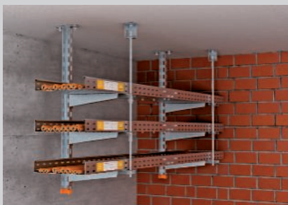
Deckenabhängung mit einseitiger Anordnung der Ausleger.
