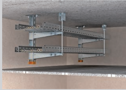
Zweilagige Deckenabhängung mit einseitiger Auslegeranordnung.
